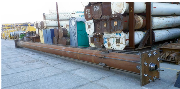
FOT. 10-11. | Po lewej stronie rama stalowa do montażu docelowych słupów stalowych, po prawej „przedłużacz”
