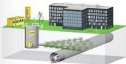
Ryc. 3. Typowy schemat iniekcji kompensacyjnej
