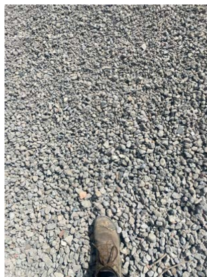
FOT. 2a i b. | Recykling betonu bezpośrednio na placu budowy do zastosowania jako materiał do kolumn żwirowych
